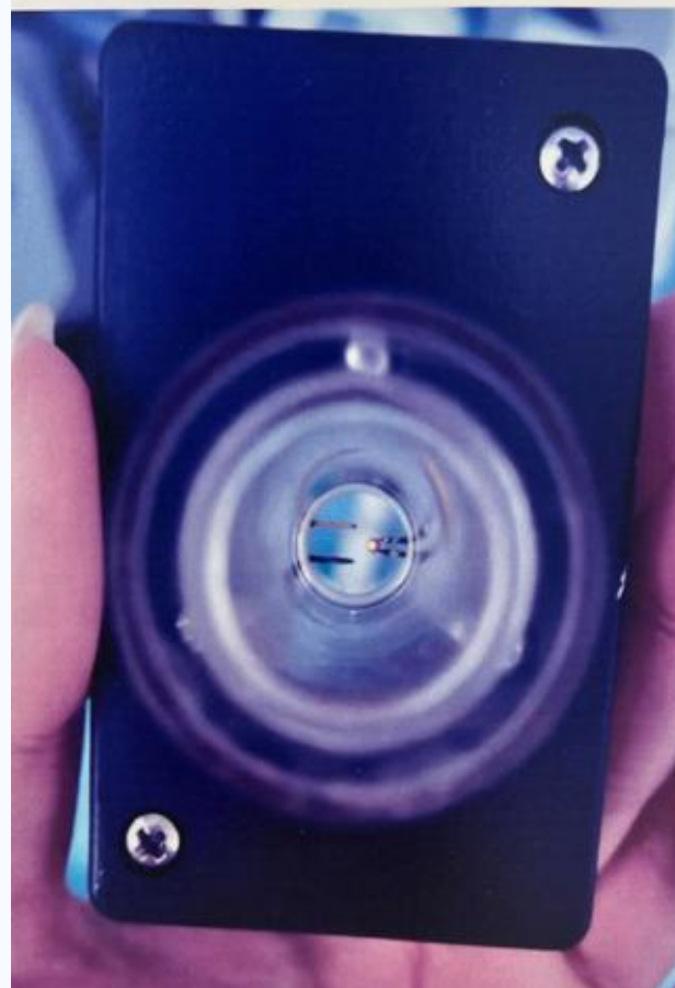
针脚锈蚀的流量传感器
